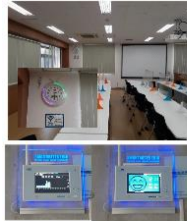
オフィス内、作業スペース内にスマートメーター、スマートクロックを設置し、電気使用量、ピーク時の見える化、節電意識向上、削減効果を共有。
