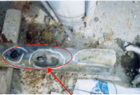
直管 150 最大孔食 8.2mm
